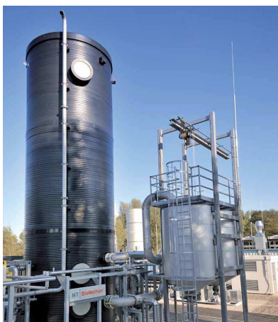
Ilustración 13 Estación de depuración de biogás en Detmold (Alemania) en el momento de inyección del biometano en la red de gas natural
