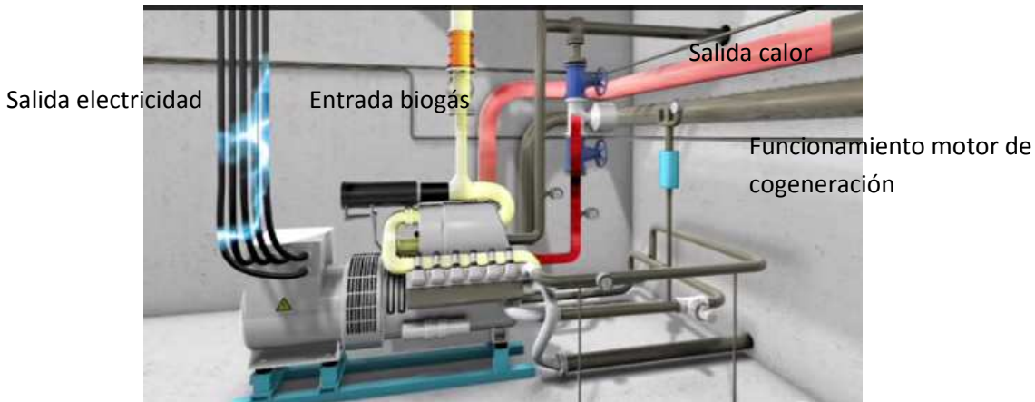
Ilustración 47 Ejemplos de motores de cogeneración
