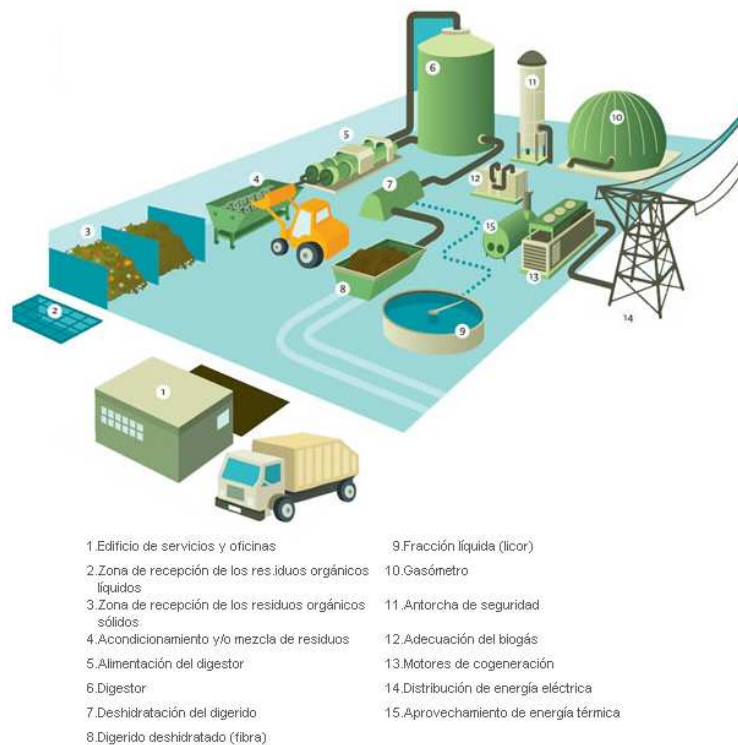
Ilustración 21 Modelo de planta de digestión anaerobia.
