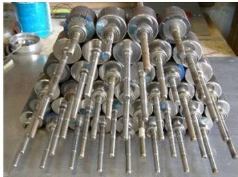
Figura 4.11. Conjunto de rotores de la serie 1 utilizados en la validación experimental.
