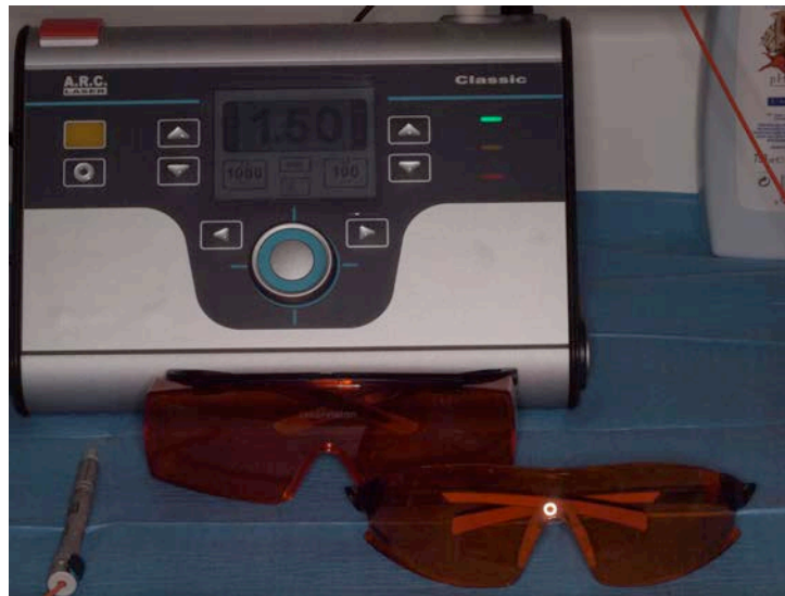
Figura 4.10 Láser de 532 nm o KTP .ARC MEDICAL LASER ®, modelo Classic Green con sus gafas de protección indicadas por el fabricante ARC.
