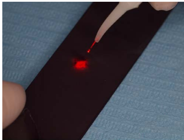
Figura 4.11 Activación con el láser de diodo de 980 nm. Efecto Hot Tip .
