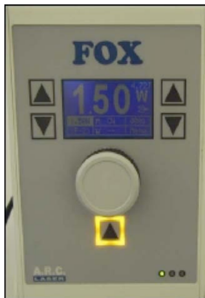
Figura 4.9 Láser de diodo de 980 nm ARC MEDICAL LASER®, modelo FOX, programado a 1,5 Vatios en onda continua.
