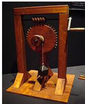
Figura 2. Engranaje helicoidal de Leonardo
