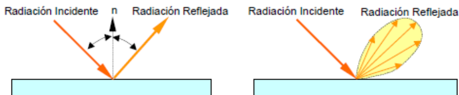
Figura 13. De izquierda a derecha, reflexión perfectamente especular y reflexión difusa (falta de especularidad)
