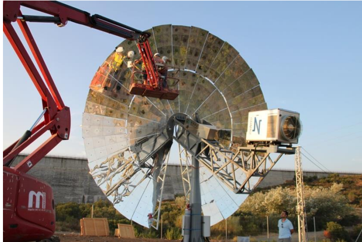
Figura 30. Personal de CTAER realizando los ensayos de fotogrametría del disco
