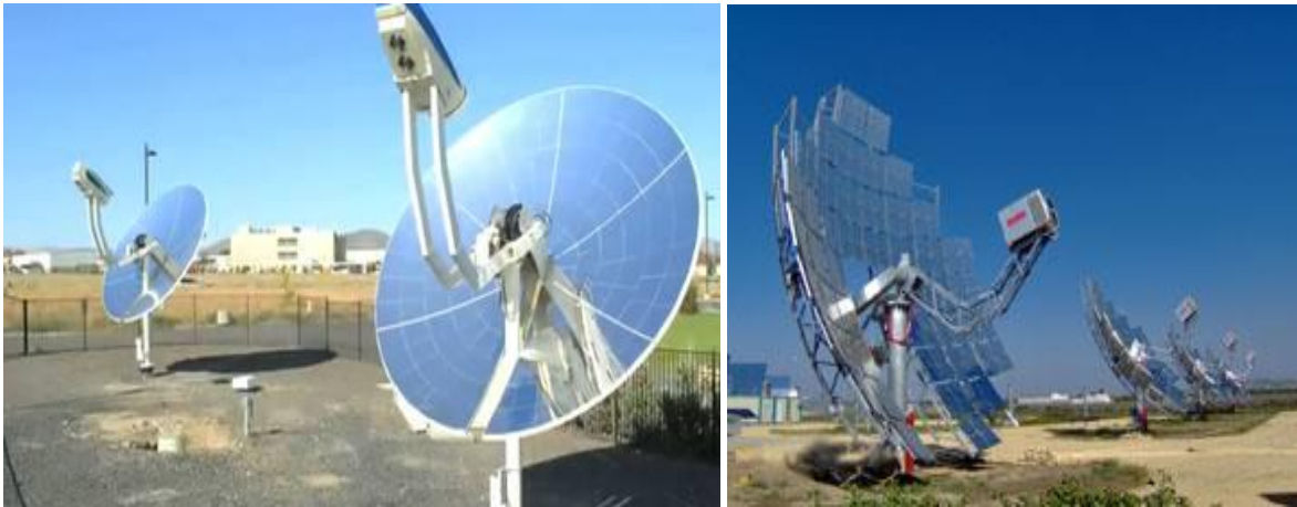
Figura 11. Izq. Sistema Infinia; der. Planta demo en Solúcar, Sevilla
