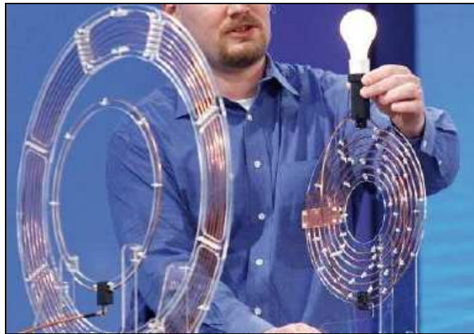
Figura 13. Demostración de Witricity (MIT).
