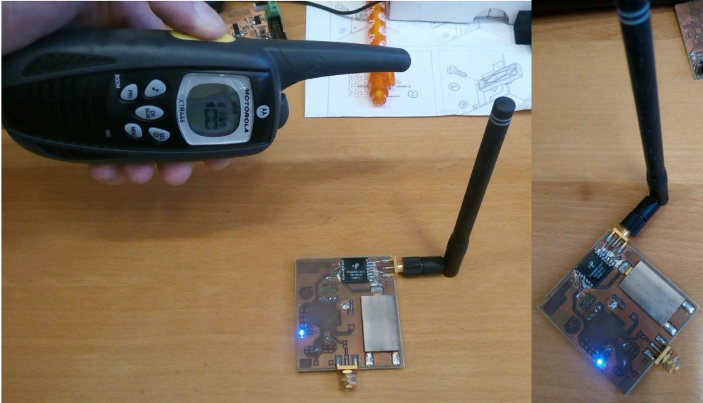
Figura 76. Prueba de Concepto generación RF
