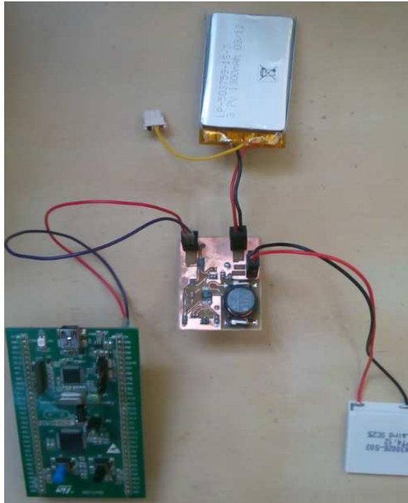
Figura 80. Prueba de Concepto con Celda Peltier
