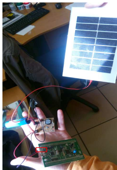
Figura 79. Prueba de Concepto Panel Solar y batería
