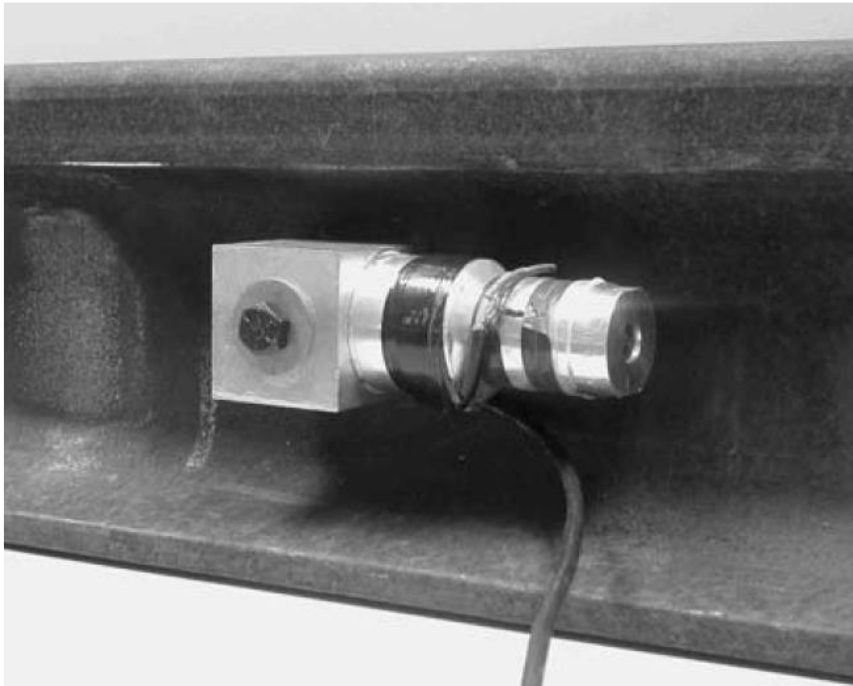
Figura 3. Transductores de ultrasonido adosados al carril.
