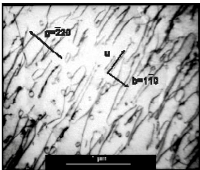
Fig. 1- Subestructura de dislocaciones en el plano de deslizamiento primario (001) de una muestra con 24 mol%  $\text{Y}_2\text{O}_3$  deformada hasta el 3% en la que se observaron inestabilidades dinámicas. Se indican el vector  $\vec{g}$ , el vector de Burgers de las dislocaciones,  $\vec{b}$ , y la línea de dislocación  $\vec{u}$ . La mayoría de las dislocaciones están en arista. La densidad media de dislocaciones se ha estimado en  $\rho=10^{13} \text{ m}^{-2}$ .
