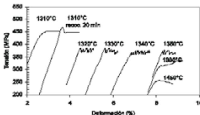
Fig. 2- Curvas tensión-deformación correspondientes a muestras con 24 mol%  $\text{Y}_2\text{O}_3$  deformadas plásticamente en compresión uniaxial tal y como se describe en la parte experimental, a una velocidad de deformación de  $\dot{\epsilon} = 1.6 \cdot 10^{-5} \text{ s}^{-1}$  y entre 1310 y 1450°C como se indica. Las curvas correspondientes a 1310°C corresponden a un experimento de envejecimiento estático (obsérvense los picos de tensión).
