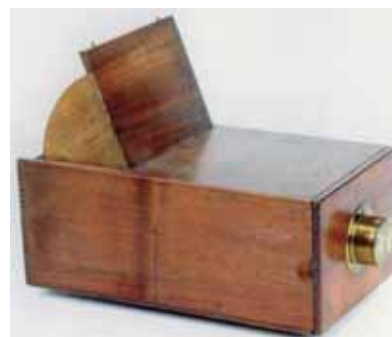
7. Cámara oscura construida en madera, siglo XIX
