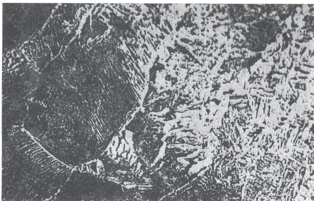
Zona de transición metal-soldadura, con estructura gruesa de la zona de recalentamiento y agregado fino de tipo troostítico, \times 250 , atacada con Nital 1.
