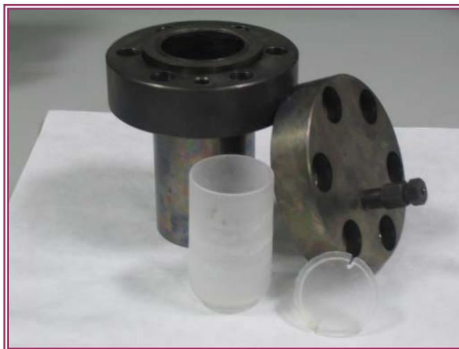
Figura 3.2. Fotografía del reactor utilizado en las reacciones hidrotermales, incluyendo la camisa de cuarzo empleada.
