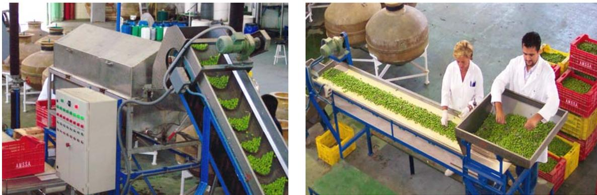
**Foto 5-** *Pasteurizadora de aceitunas de mesa utilizada para el tratamiento térmico a escala Industrial*
