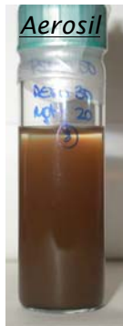
Figura 101. Aspecto de una suspensión de magnetita elaborada con Aerosil en medio orgánico tras 24 horas en reposo
