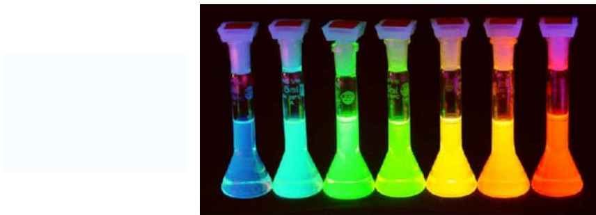
Figura 65. Fluorescencia emitida por quantum dots de seleniuro de cadmio (CdSe) al exponerlos a la luz ultravioleta ( http://en.wikipedia.org/wiki/Fluoresce , 2007)
