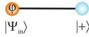
Figura 3.8: Rotación de un qubit lógico representada por un estado cluster de dos qubits. El primero se encuentra en el estado |\psi_{in}\rangle y el segundo en el estado |+\rangle . Para obtener como resultado el giro de un qubit lógico se aplica sobre el primer qubit el operador P_\varphi .
