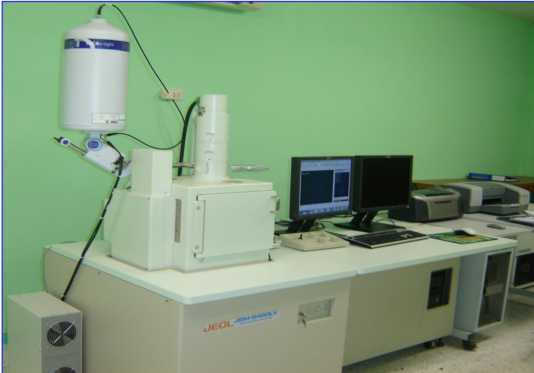
Fig. 17 Microscopio electrónico de barrido (M.E.B. JEOL Mod. JEOL-6480V)
