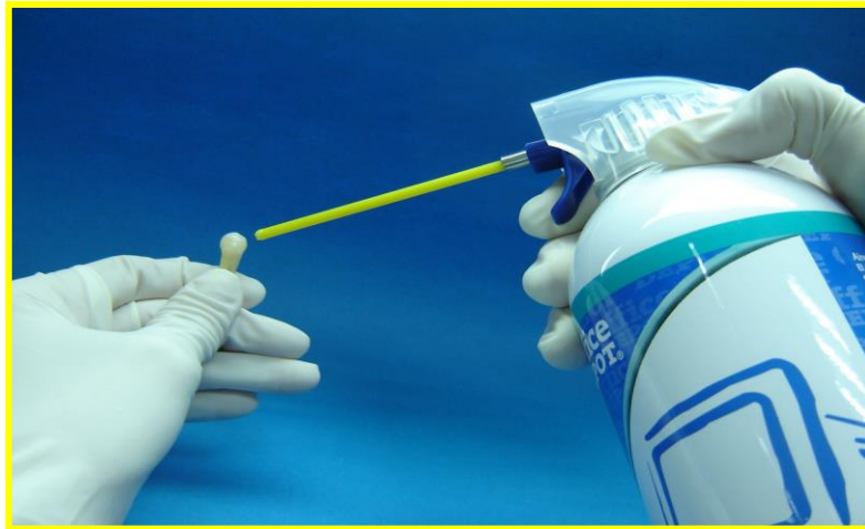
Fig.27 Después de lavar se procedió a secar con aire comprimido.
