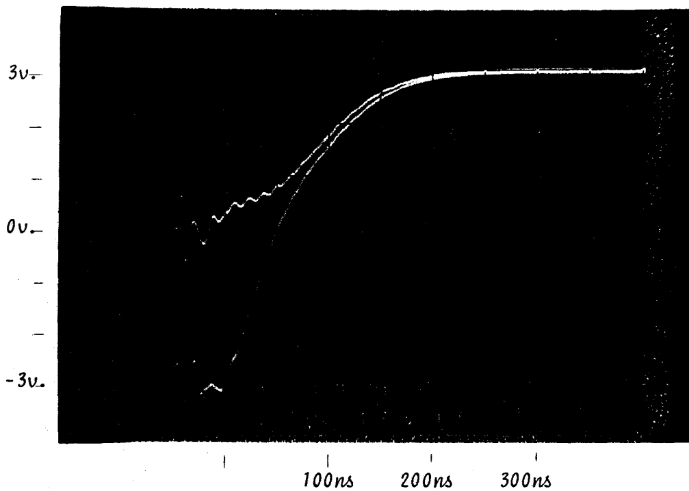
Fig. 6.5.5: Oscilograma de la transición de 0 a 2 del circuito experimental de la figura 6.5.1. ( C_L'' = 20 pF)
