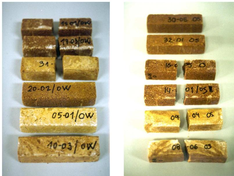
Figura 42. Rotura de probetas prismáticas de control OW y OS a flexión
