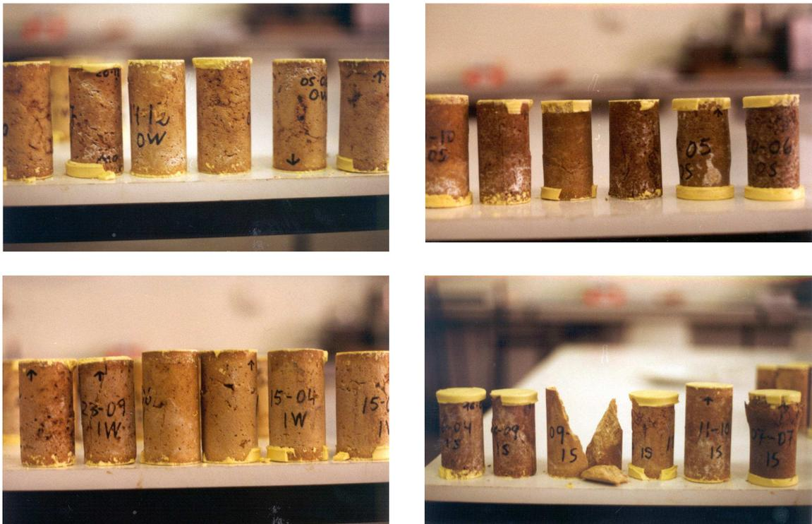
Figura 25. Rotura de probetas cilíndricas de control de cada una de las dosificaciones ensayadas a compresión, correspondientes a la Figura 22
