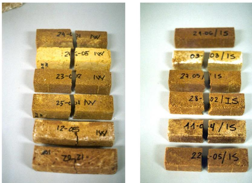
Figura 44. Rotura de probetas prismática de control IW e IS a flexión
