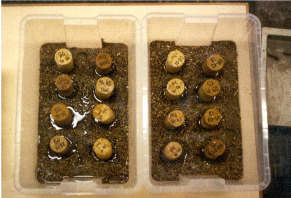
Figura 62. Ensayo de succión de agua por capilaridad
