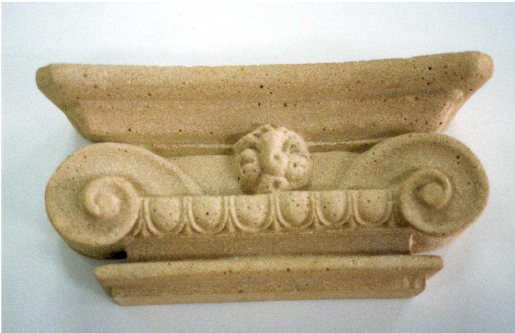
*Figura 7. Probeta decorativa: capitel preparada en los laboratorios de la E.T.S.A.*
