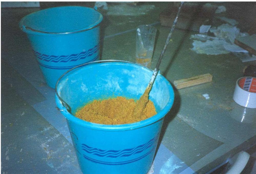
*Figura 15. Polialbero: aspecto final del mortero, antes de ser colocado*
