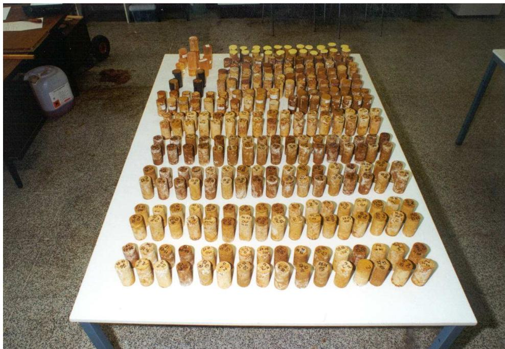
*Figura 19. Probetas cilíndricas preparadas en los laboratorios de la E.T.S.A. antes de iniciarse los ensayos*
