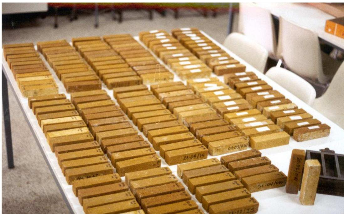
*Figura 17. Probetas prismáticas preparadas en los laboratorios de la E.T.S.A. antes de iniciarse los ensayos*
