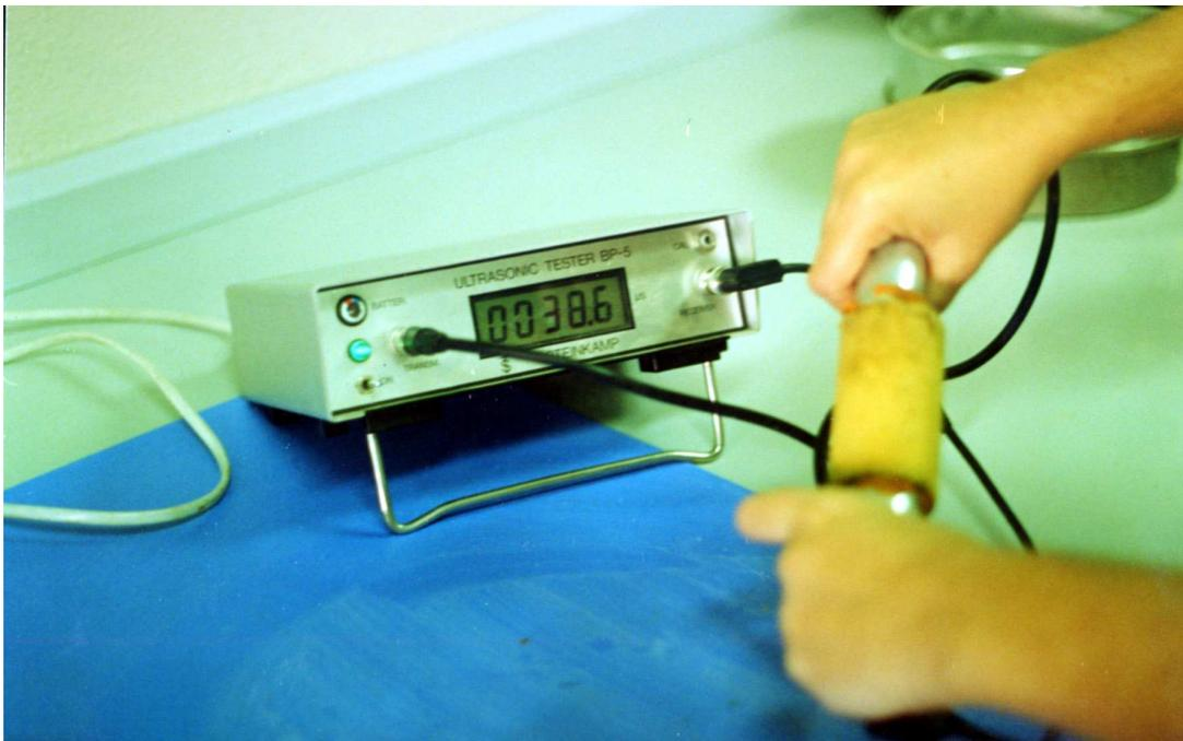
*Figura 56. Ensayo ultrasonido: toma de datos en probetas cilíndricas.*
