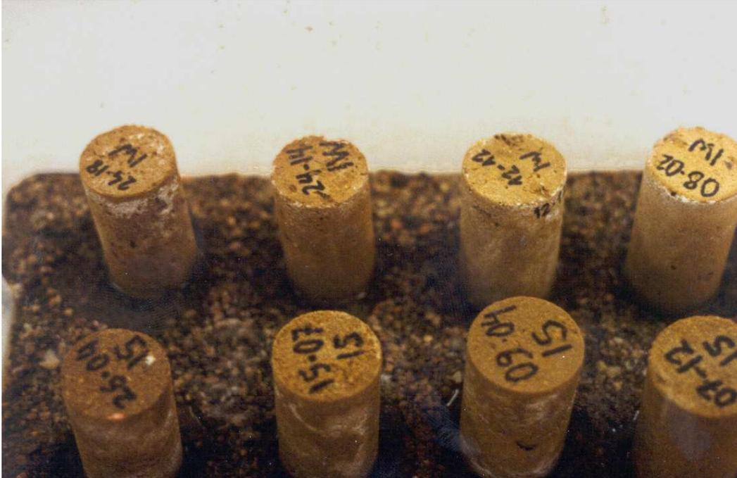
*Figura 73. Ensayo de succión de agua por capilaridad. Subida del frente capilar*
