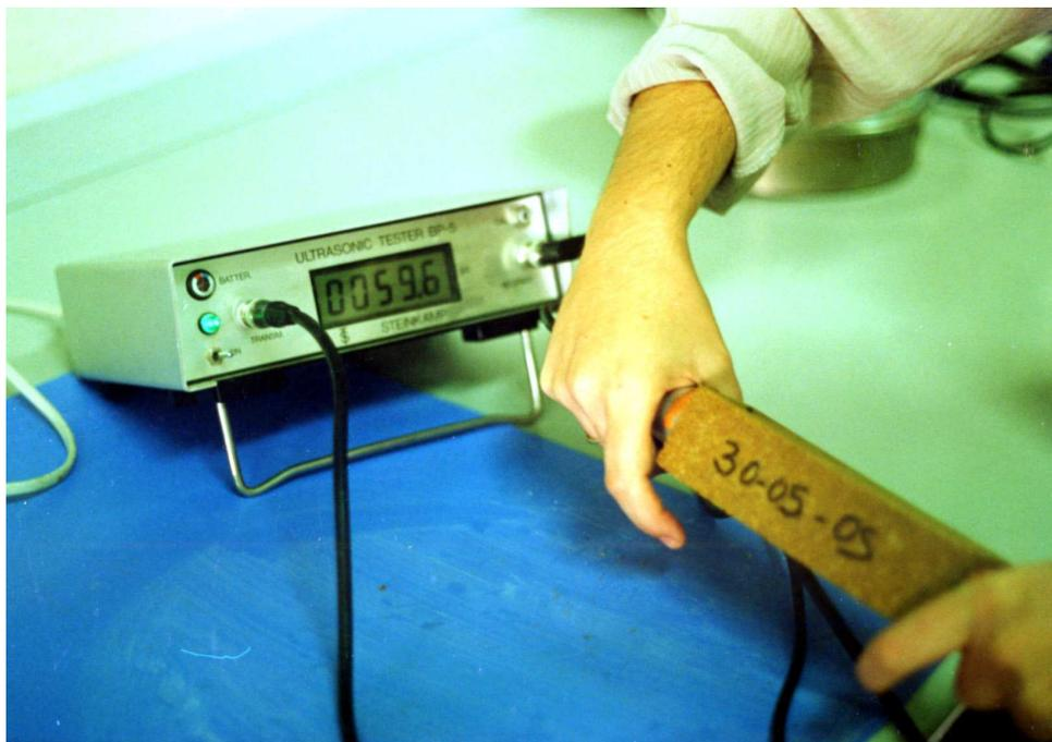
*Figura 57. Ensayo ultrasonido: toma de datos en probetas prismáticas.*
