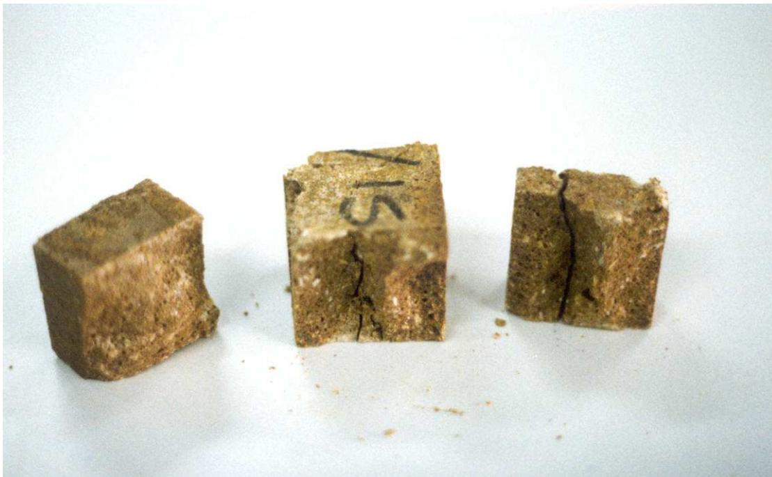
*Figura 37. Restos de la probeta prismática después del ensayo. Rotura frágil, probeta IS*
