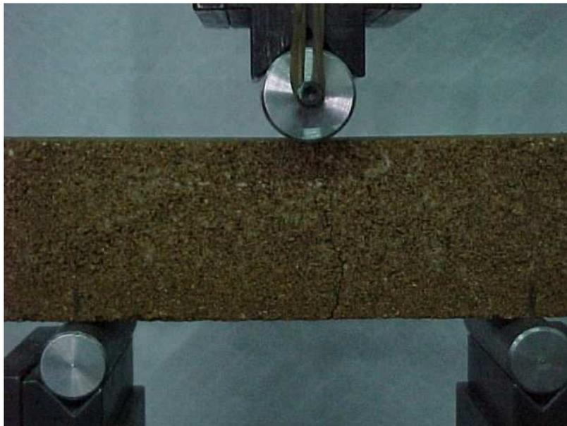
Figura 47. Ensayo de flexión en probetas prismática tras ciclos (1+2) en la cámara climática.
