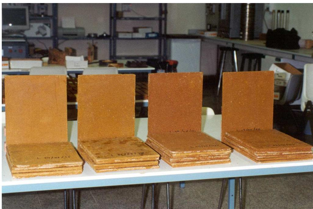
Figura 74. Probetas losas preparadas en los laboratorios de la E.T.S.A. para ser enviadas a ensayo en cámara de radiación
