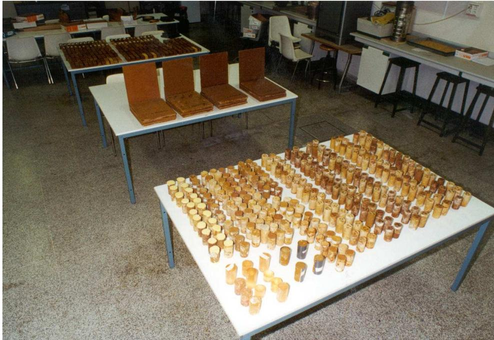
*Figura 8. Algunas de las probetas preparadas en los laboratorios de la E.T.S.A. antes de iniciarse los ensayos*
