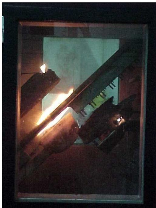
*Figura 77. Momento de inflamación de la probeta*
