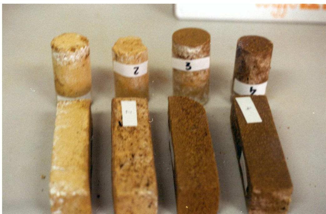
Figura 14. Distintos patrones de color en probetas de mortero polimérico de albero
