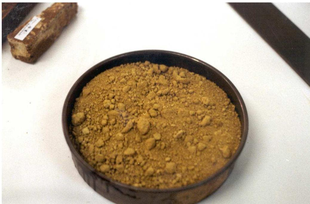
Figura 12. Albero secado para la fabricación del mortero polimérico
