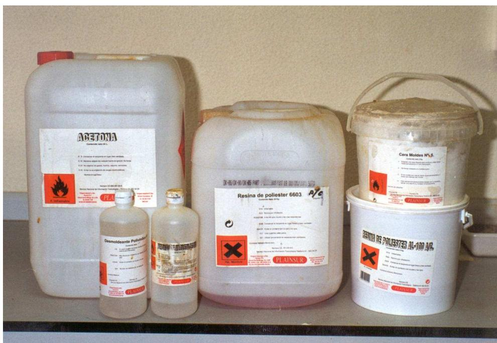
Figura 11. Materiales utilizados para la fabricación del mortero polimérico
