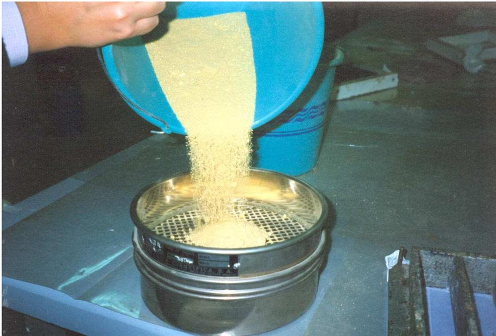
*Figura 13. Tamizado del albero para la fabricación del mortero polimérico*
