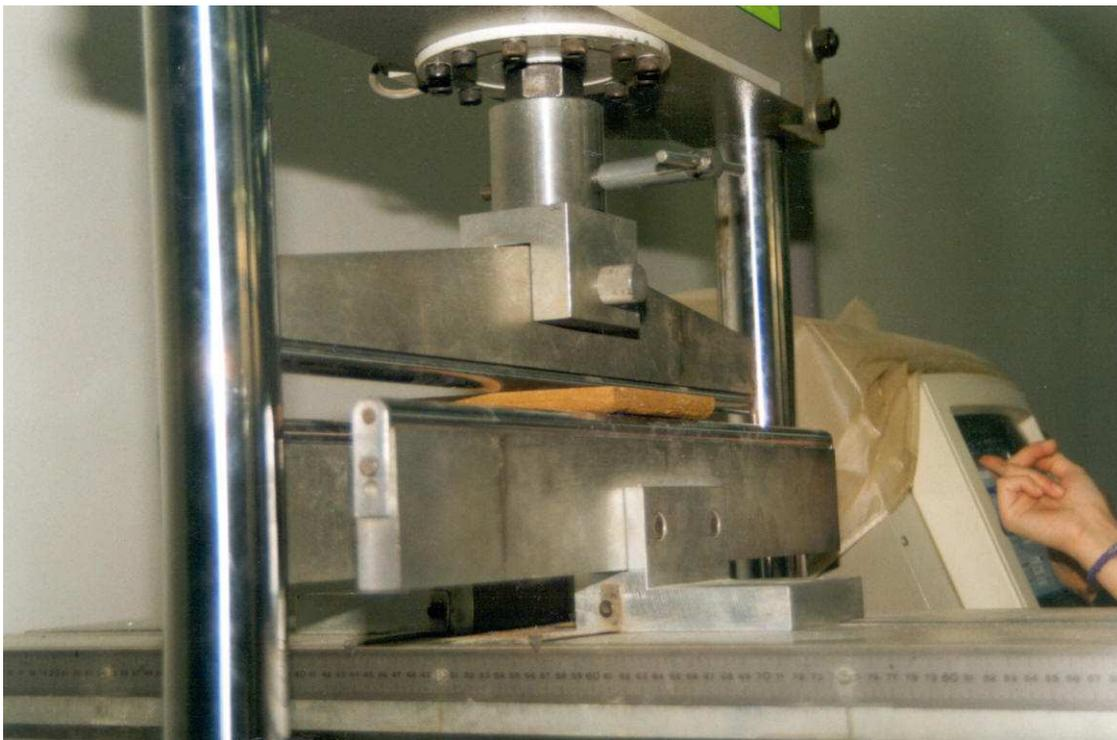
*Figura 48. Ensayo de resistencia a flexión probetas baldosas de control*
