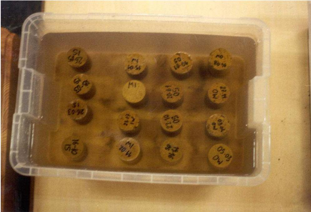
Figura 61. Ensayo de absorción de agua por inmersión a presión atmosférica
