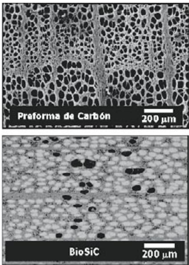
Fig. 2- Fotomicrográficas de la preforma de carbono (a) y del BioSiC (b), ambos corte perpendicular a la dirección axial.
