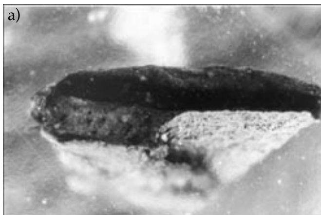
Fig.2.- Microfotografías al microscopio óptico de una preparación estratigráfica (estratigrafía), sección transversal, de un fragmento extraído de una pintura mural, correspondiente al soporte y capa pictórica: a) aumento (x20) y b) aumento (x60).
