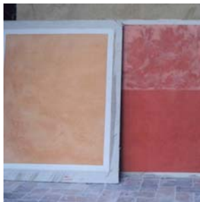
Figuras 7 y 8. Muestras de ensayo de color con mortero de estuco sobre placas de cartón-yeso.
