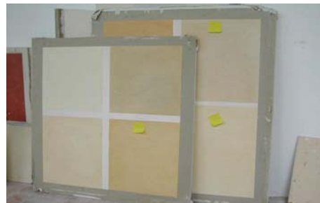
Figuras 7 y 8. Muestras de ensayo de color con mortero de estuco sobre placas de cartón-yeso.
