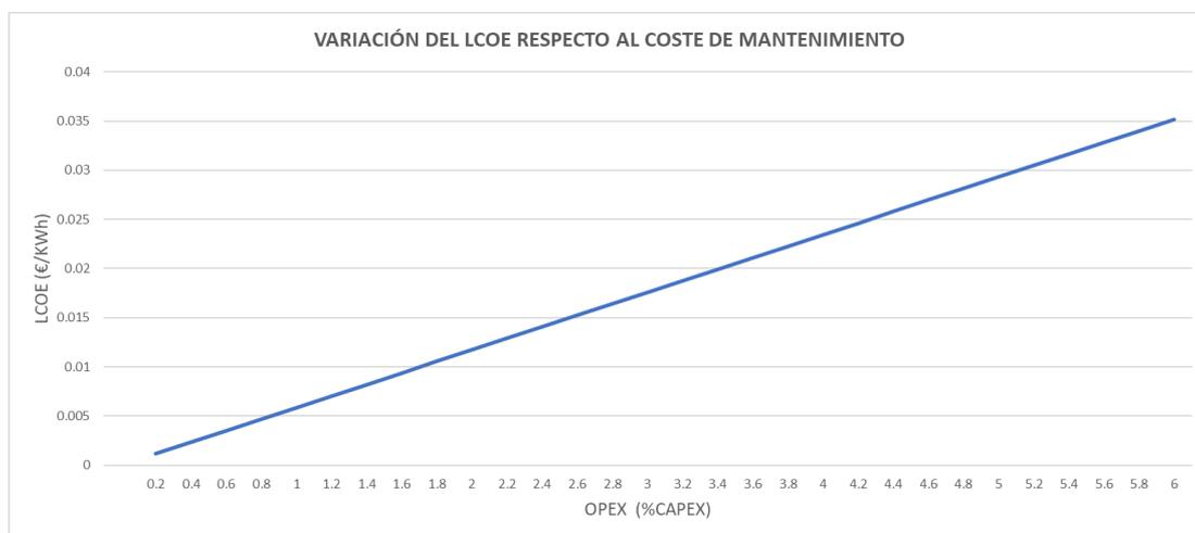
Gráfica 33. Variación del coste nivelado de la energía respecto al coste de mantenimiento.
