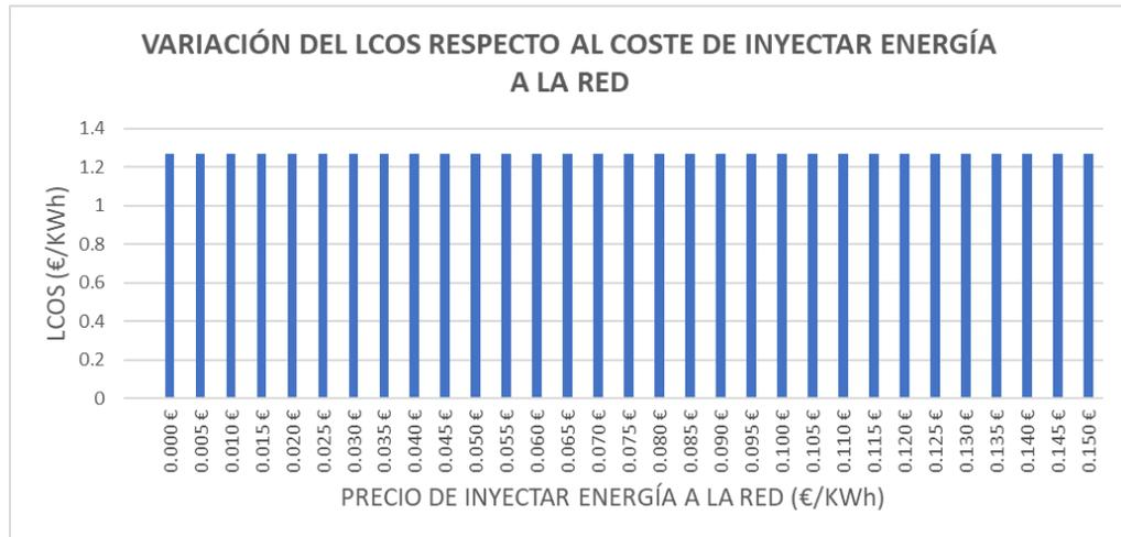
Gráfica 42. Variación del coste nivelado de almacenar energía respecto al precio de inyectar energía a la red.
