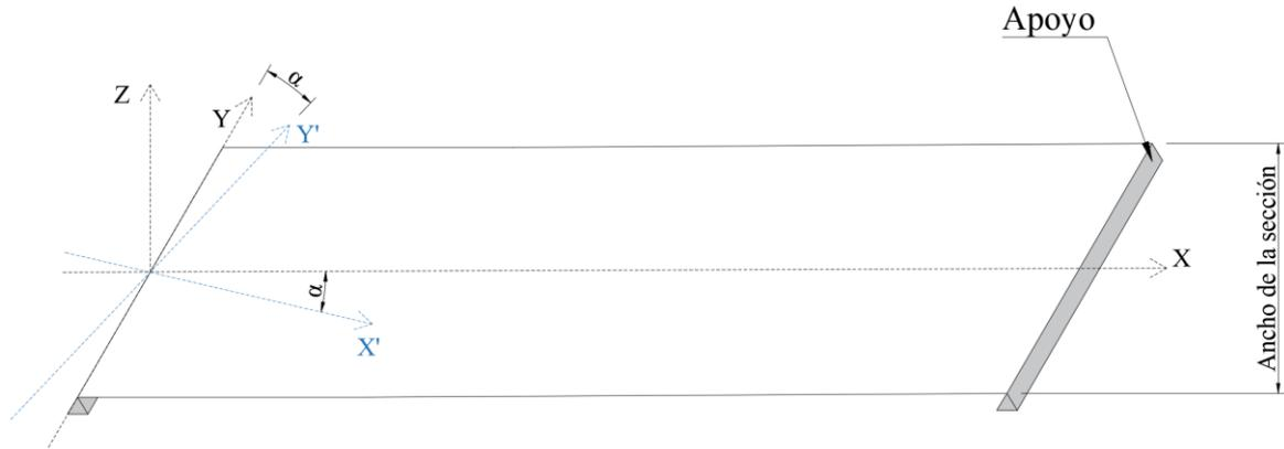
Figura 4: Representación tridimensional de viga biapoyada con esviaje y condiciones de contorno [2].
