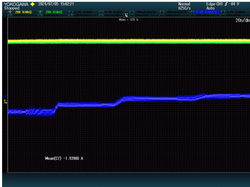
Figura 5.16 Tensión y corriente medidas en el equipo de control de corriente.
