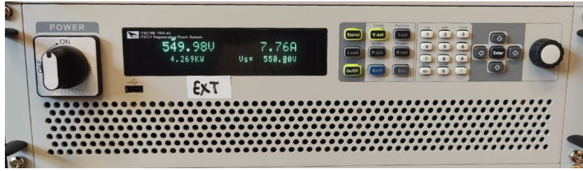
Figura 5.10 Mediciones en la fuente externa del convertidor.
