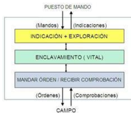
Figura 5. Estructura de un enclavamiento
