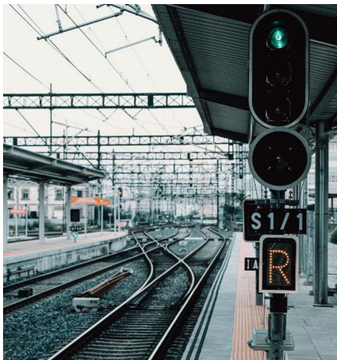
Figura 11. Señal ferroviaria de salida de una estación, con aspecto verde indicando vía libre al maquinista.
