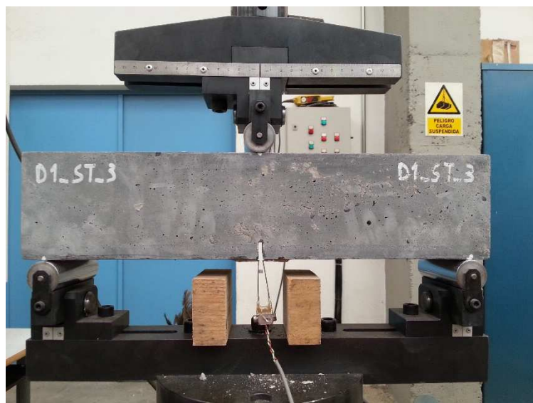
Figura 2. Ensayo estático de flexión a tres puntos.
