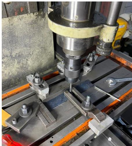
Figura 8: Mecanizado del agujero mediante taladrado.
