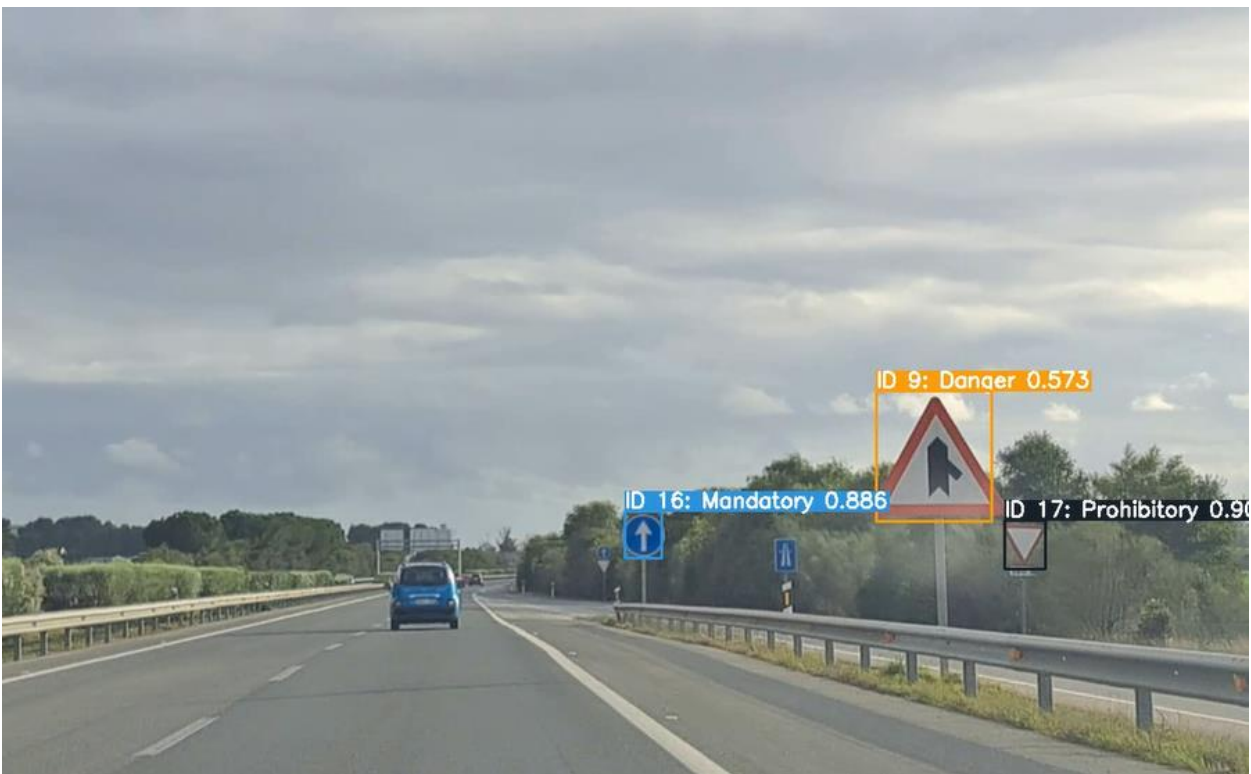
Figura 7-4. Ejemplo de fotograma del video de prueba 01. Señales con detección y clasificaciones correctas (YOLOv8)
