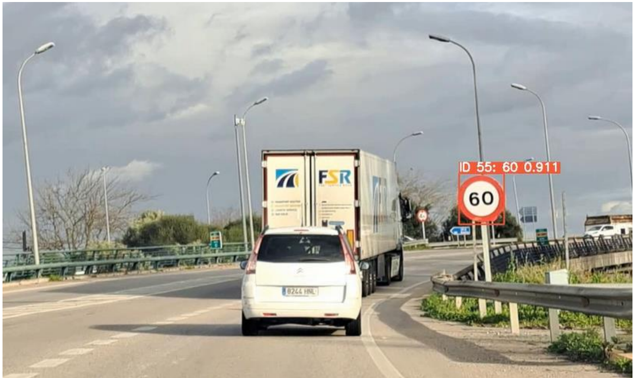
Figura 7-5. Ejemplo de fotograma del video de prueba 01. Señal con detección y clasificación correctas. (YOLOv8, ResNet-50)
