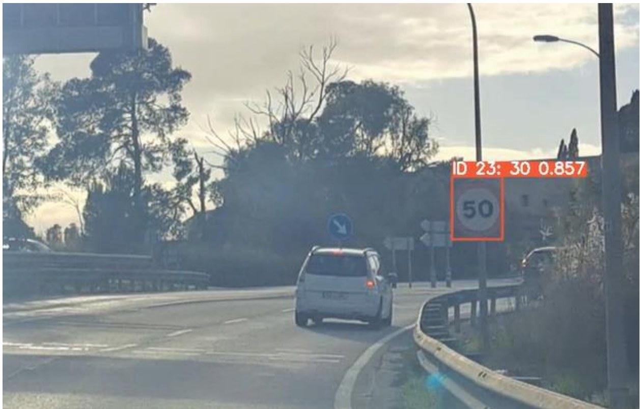
Figura 7-6. Ejemplo de fotograma del video de prueba 01. Señal con detección y clasificación correctas (YOLOv8) pero clasificación secundaria errónea. (ResNet-50)
