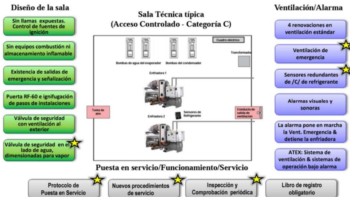
Ilustración 54. Conjunto de medidas de seguridad necesarias para ubicación de enfriadoras en sala técnica típica
