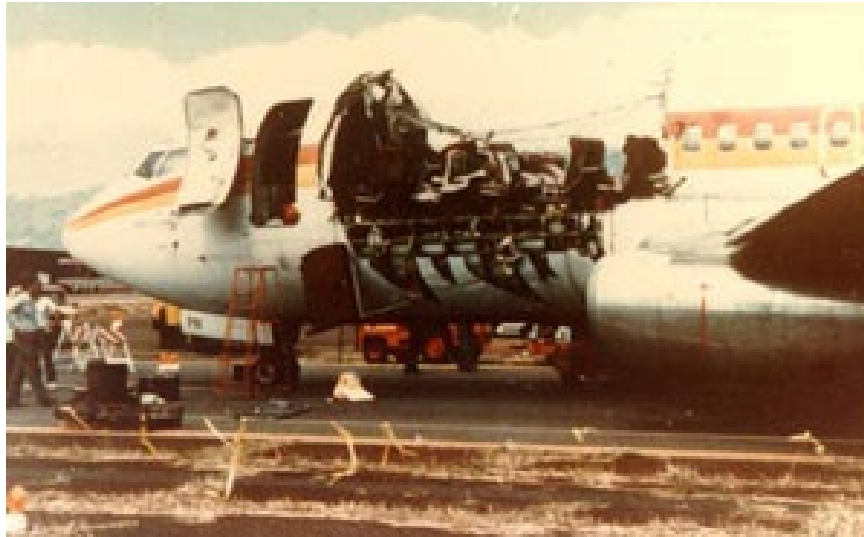
Figura 1-5. Daño en el fuselaje del vuelo 243 de Aloha Airlines [11].
