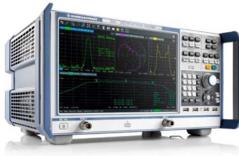
Figura 3-5. Rohde & Schwarz ZND Vector Network Analyzer. Extraído de la página del fabricante [12].
