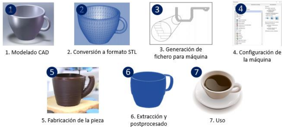
Ilustración 2. Procesos de la Fabricación Aditiva (Gibson et al., 2021)
