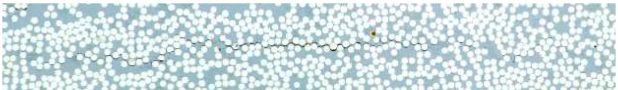
Figura 47. Grieta longitudinal en estado prístino en la en la zona de refuerzo de la probeta de tipo A alejada de la capa de 0° A-2.
