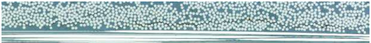
Figura 45. Grieta longitudinal en estado prístino en la zona de refuerzo de la probeta de tipo A cerca de la capa de 0° A-4.
