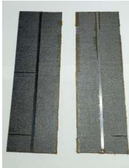
Figura 18. Laminados obtenidos tras el curado del adhesivo.
