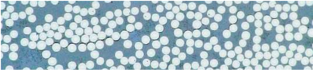
Figura 49. Grupos de despegues en estado prístino en la zona de refuerzo de la probeta de tipo B.
