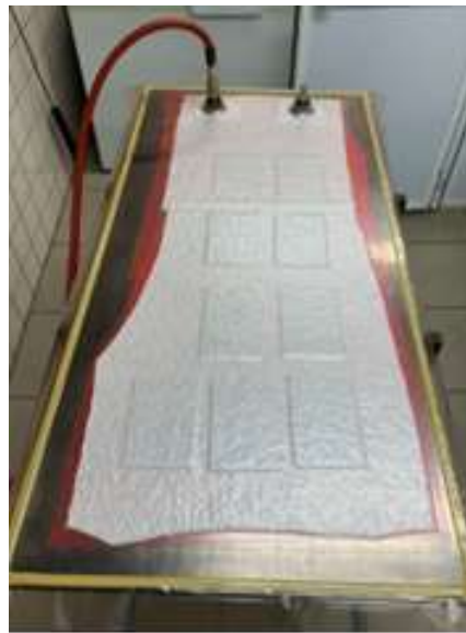
Figura 11. Bolsa de vacío para el curado del laminado [7].
