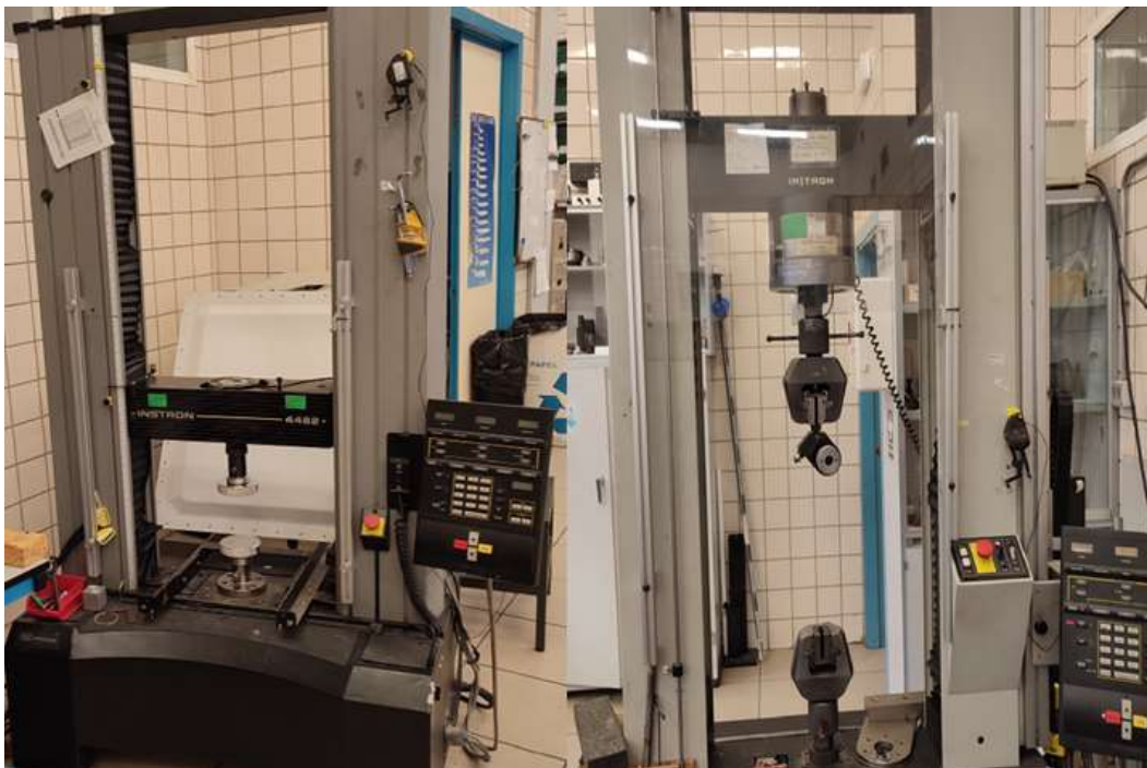
Figura 20. Máquinas de ensayo Instron, modelos A) 4482 y B) 4483
