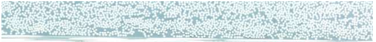
Figura 44. Grieta longitudinal en estado prístino en la zona de refuerzo de la probeta de tipo A cerca de la capa de 0° A-3.
