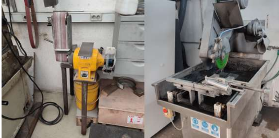
Figura 14. A) Abrasión por rueda. B) Disco de corte refrigerado por agua.
