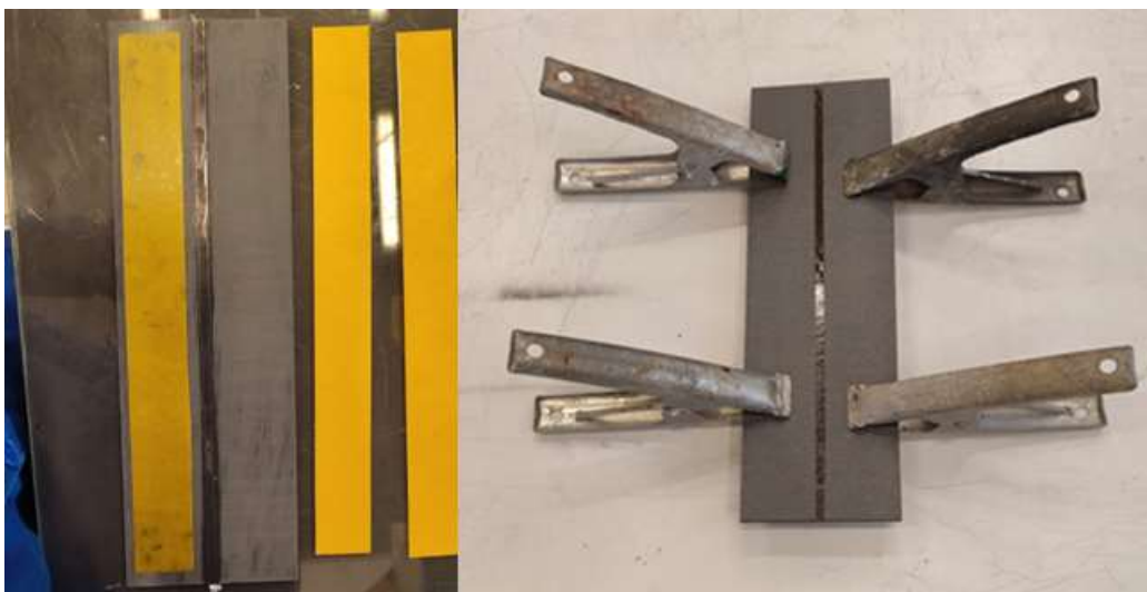
Figura 15. Aplicación del adhesivo.
