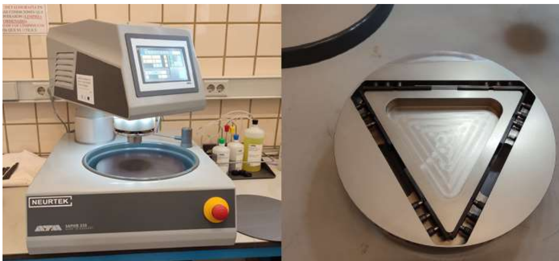
Figura 19. A) máquina de pulido. B) útil de pulido.
