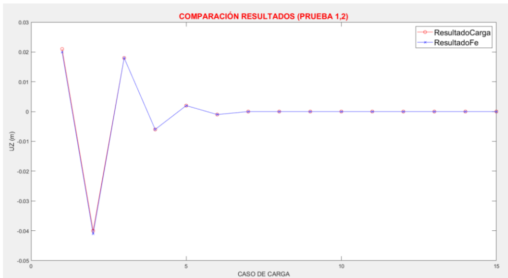
Figura 4.25 Resultados gráficos del segundo caso de carga. Desplazamientos aproximados vs referencia.
