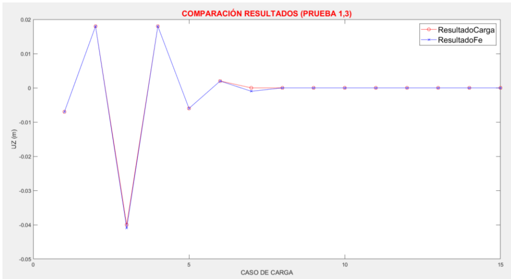
Figura 4.26 Resultados gráficos del tercer caso de carga. Desplazamientos aproximados vs referencia.
