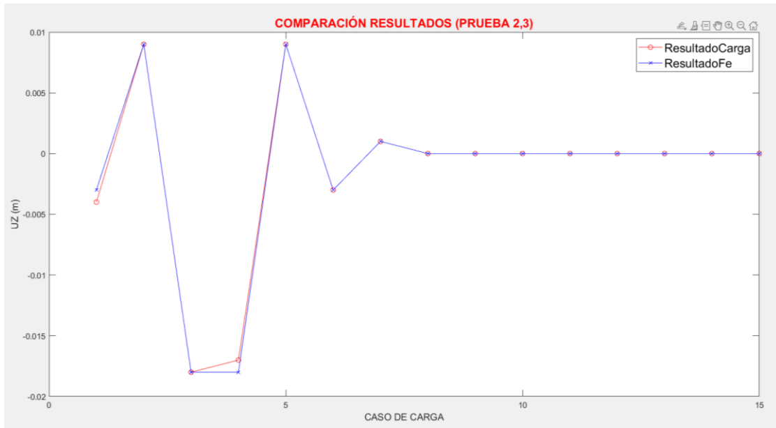
Figura 4.37 Resultados gráficos del tercer caso de carga. Desplazamientos aproximados vs referencia.
