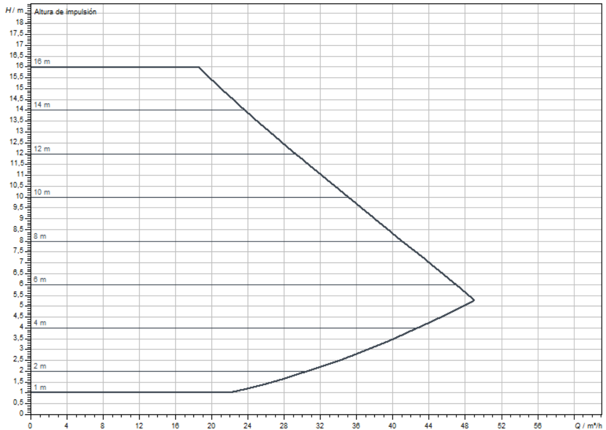
Figura 42. Curva característica H-Q de la bomba seleccionada (21).
