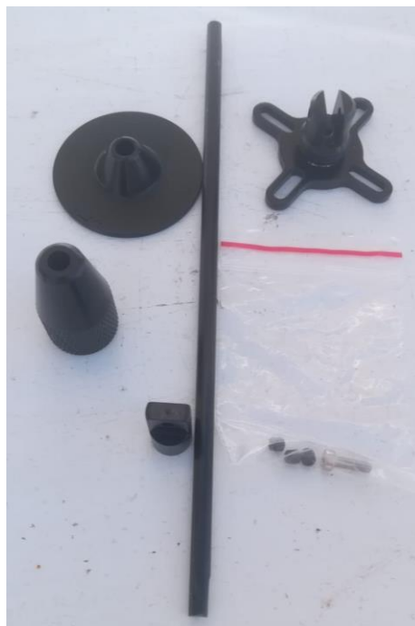
Ilustración 33. Elementos que componen el mástil del GPS y tornillería
