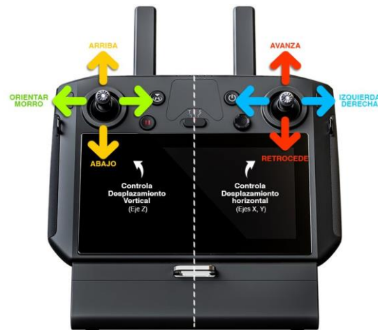
Ilustración 22. Canales de control para modo de vuelo “Position”
