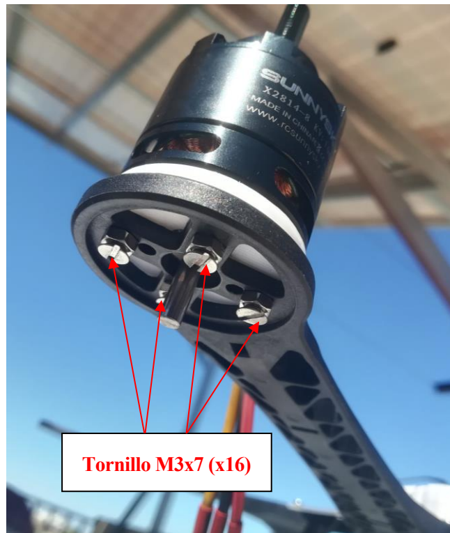
Ilustración 38. Montaje de los motores
