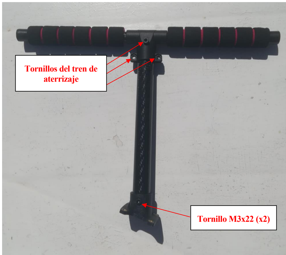
Ilustración 25. Montaje del tren de aterrizaje
