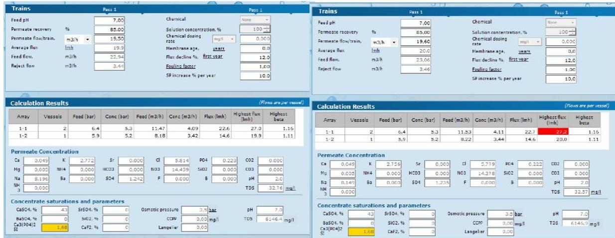
Figura 55: Simulación IMS Design para ver el caudal de permeado a 22°C para el segundo caso.
