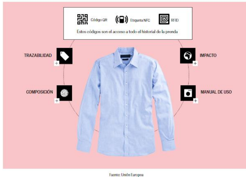
Figura 3. Esquema del pasaporte digital de prendas (Fuente: [10])
