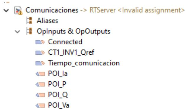
Figura 5-4. Etiquetas del modelo en RT-LAB
