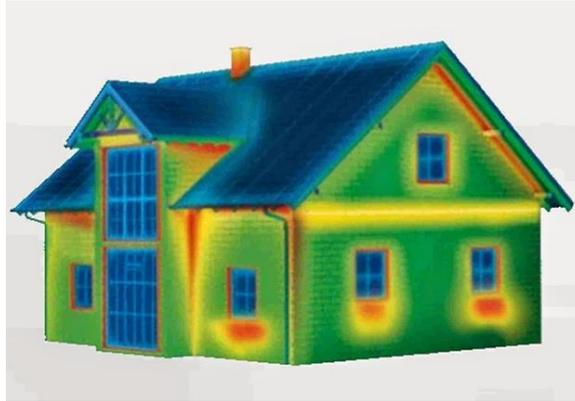
*Ilustración 4. Puentes Térmicos de la Envolvente.*
