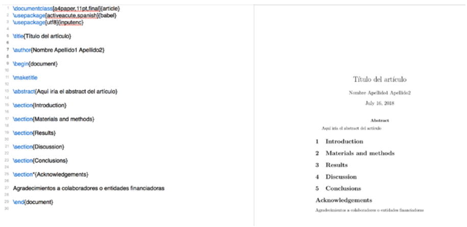
Figura 4.17. Ejemplo de artículo generado en LaTeX: código fuente (izquierda) y documento generado (derecha).
