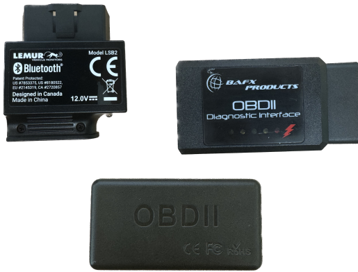
Figura 1. Ejemplos de dongles OBD comerciales. De arriba a abajo, izquierda a derecha: (a) BlueDriver (modelo LSB2) de Lemur Vehicle Monitors, (b) Bluetooth OBDII Reader de Bafx Products, (c) lector genérico compatible con el protocolo ELM327.
