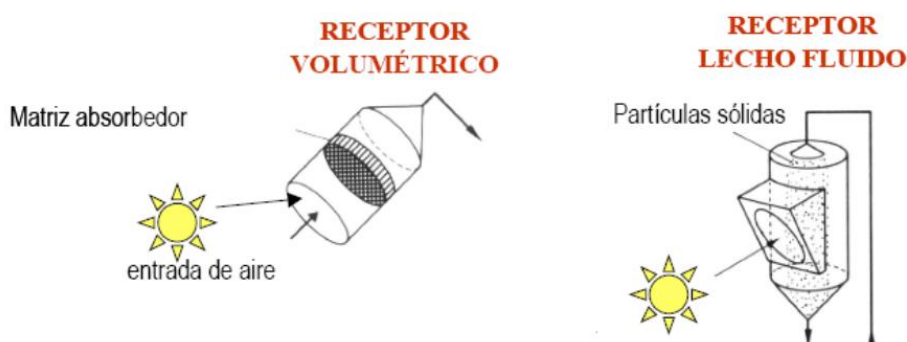
Ilustración 4: Receptor volumétrico y de lecho fluido [3]
