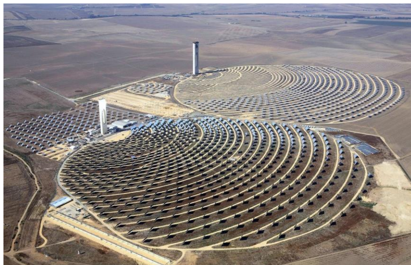
Ilustración 12: Distribución campo de heliostatos orientado al Norte (PS10 y PS20, en la Plataforma Solar de Sanlúcar la Mayor) [10]
