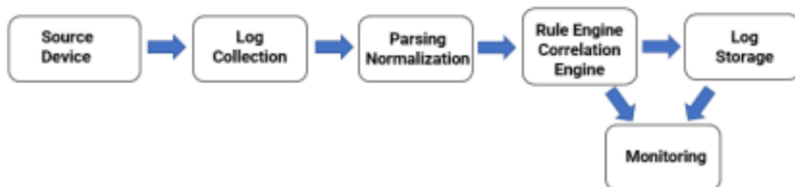
Figura 35. Arquitectura básica de un SIEM [74].
