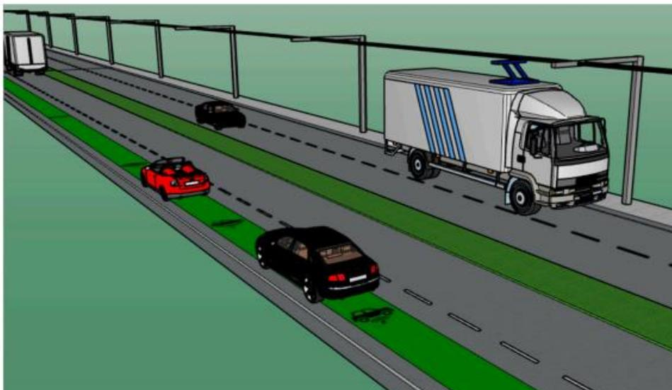
Figura 1: Ilustración de eRoad con carga conductiva e inductiva. [3]
