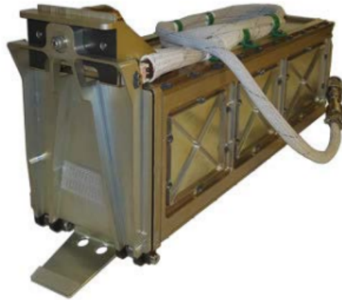
Imagen 18. Poly Picosatellite Orbital Deployer (P-POD) desarrollado por Cal Poly.
