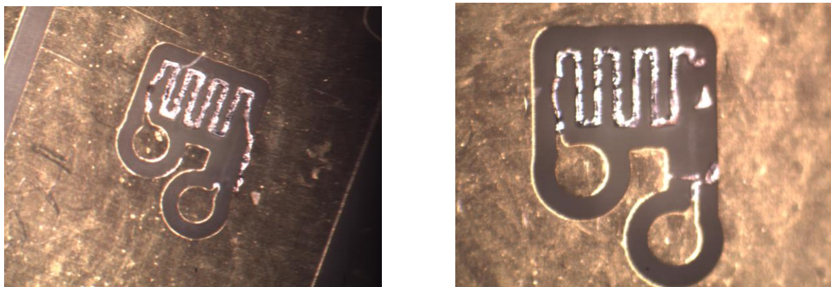
Figura 5.19 Aspecto de las resistencias al fundirse por descarga del condensador
