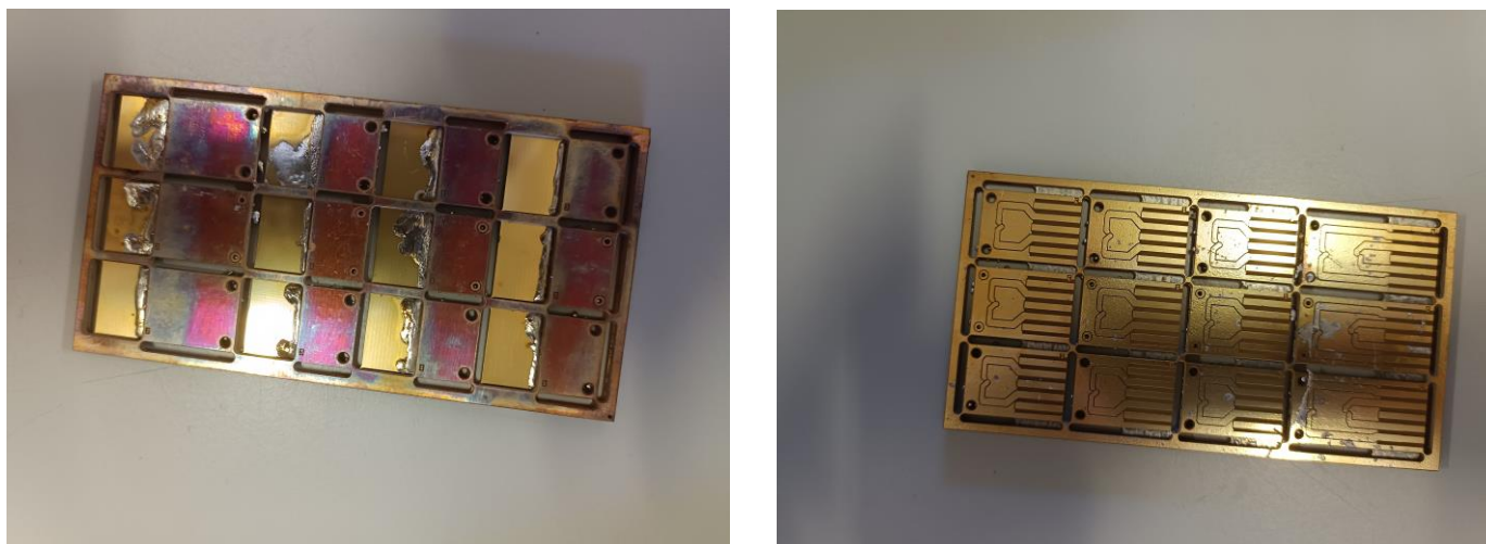
Figura 1.2 Matriz de Micro Thrusters soldada
