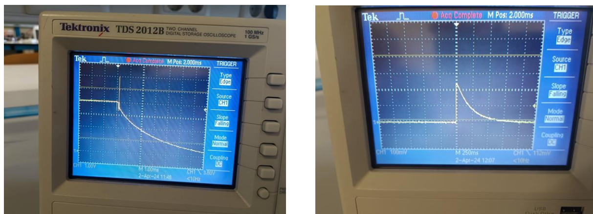
Figura 5.17 Formas de onda de las tensiones del condensador y la resistencia antes de rotura de esta última (4 V) en prueba 2
