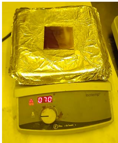
Figura 4.14 Placa térmica con PCB encima
