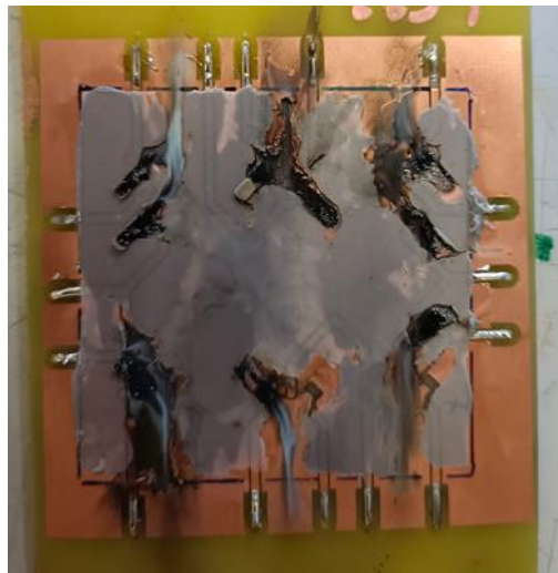
Figura 5.20 Resultados de las combustiones sobre la placa PCB
