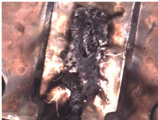
Figura 5.15 Resultado de la combustión de la prueba 11 al madurar en depósito
