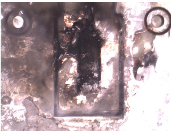
Figura 5.14 Disparos exitosos, pero con un sellado deficiente o tobera bloqueada que rompió los depósitos
