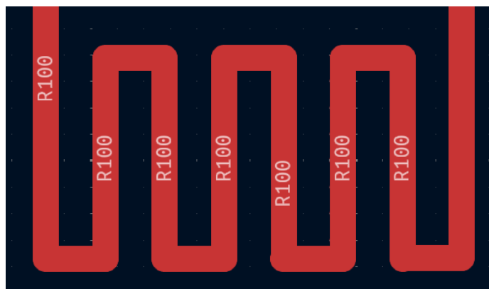
Figura 3.39 Diseño 3: Resistencia de 100 \mu m
