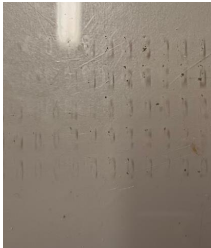
Figura 2.9 Superficie de metacrilato con cavidades fresadas
