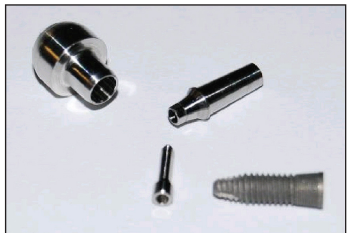
Fig. 1. Componentes del complejo implante-pilar (implante, pilar, tornillo de conexión) así como el casquillo externo para el test de fatiga cíclica.
