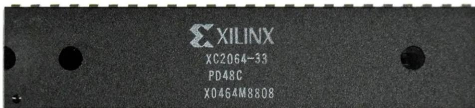
**Figura 4. FPGA XC2064 de Xilinx. Fuente: [7]**
