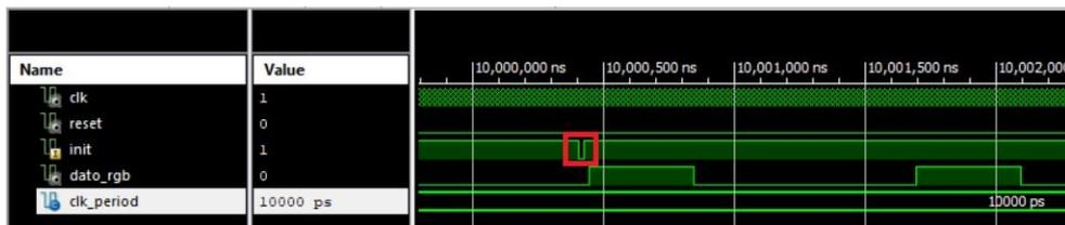
**Figura 71: Nueva transmisión de datos tras flanco de subida de “init”.**
