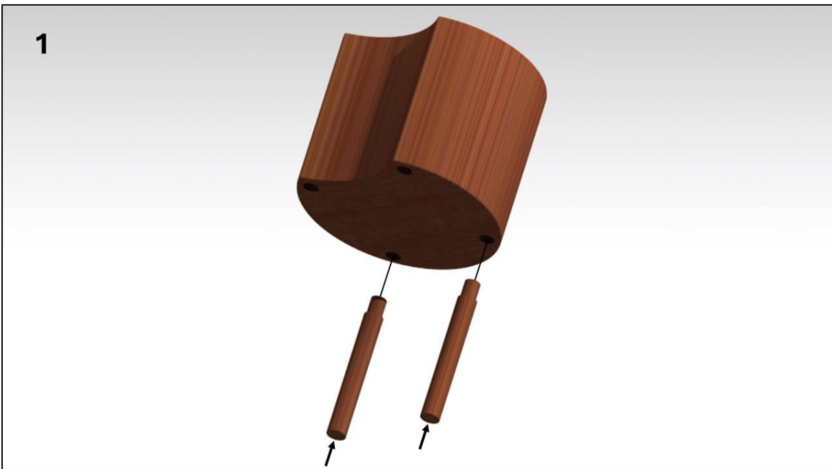
Ilustración 127. Paso 1 ensamblaje silla como banco alto.
