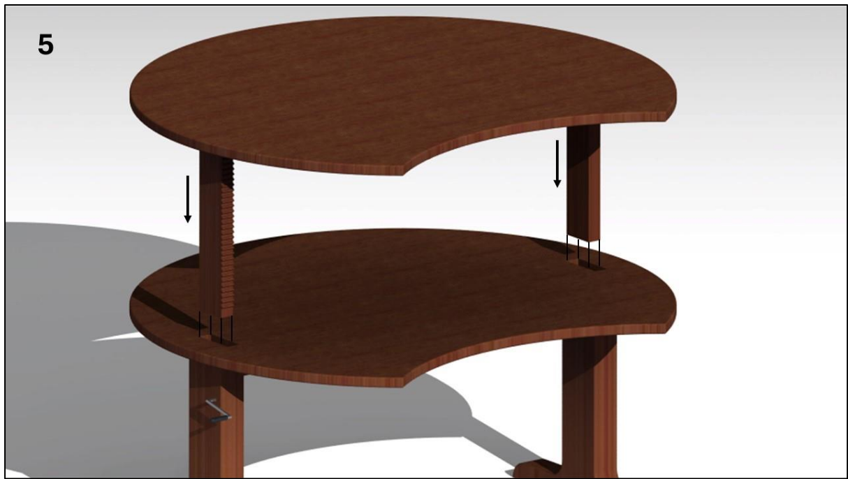
Ilustración 140. Paso 5 ensamblaje mesa: unión tablero superior, tablero inferior y patas.
