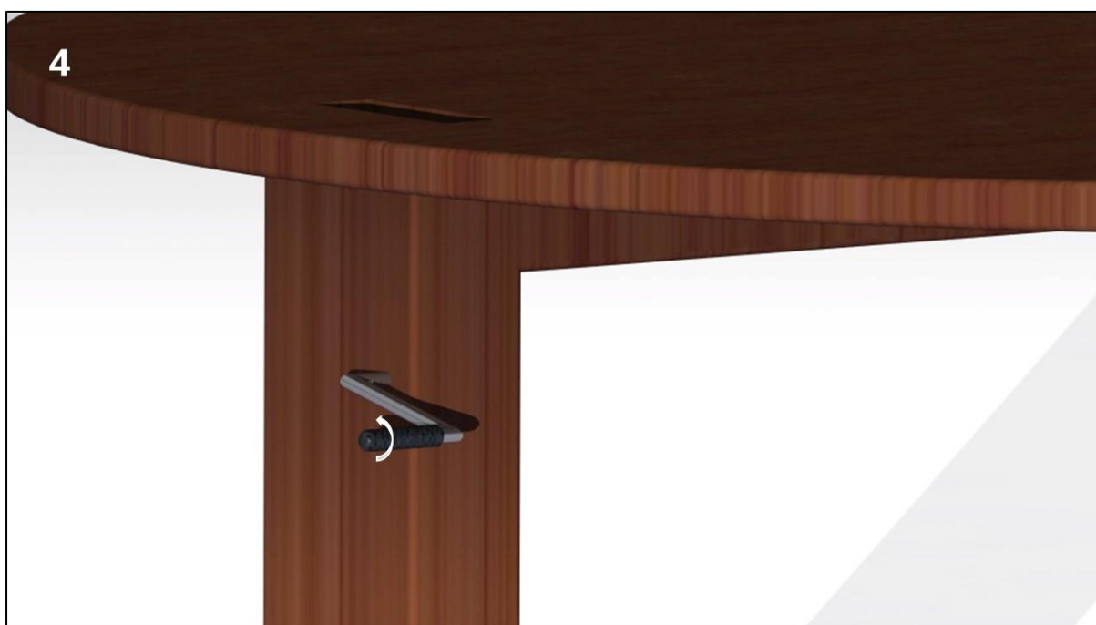
Ilustración 139. Paso 4 ensamblaje mesa: ilustración explicativa giro manivela.
