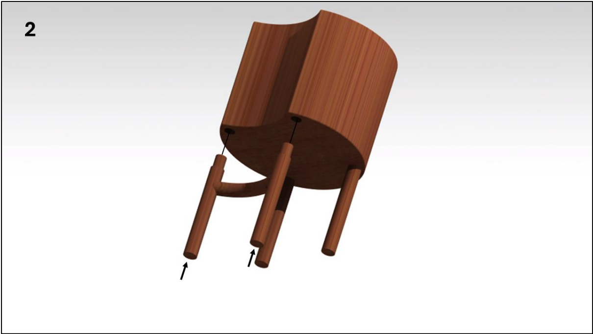
Ilustración 128. Paso 2 ensamblaje silla como banco alto.
