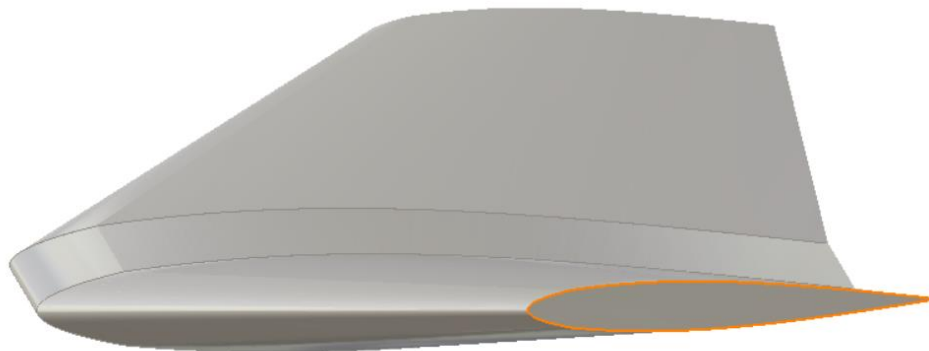
Figura 4-84. Detalle del perfil NACA 0012
