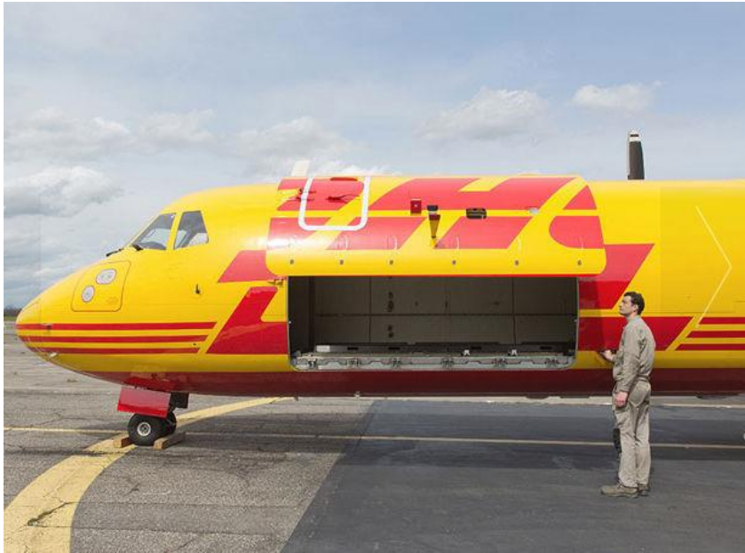
Figura 2-8. Puerta de carga de mayores dimensiones
